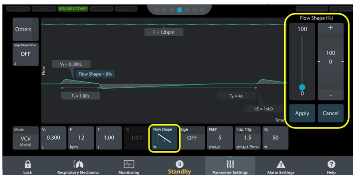
شکل ۴۷- تغییر شکل نمودار در مد تنفسی VCV
