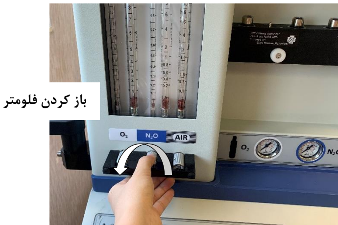
شکل ۲۲- جهت باز و بسته کردن فلومتر
