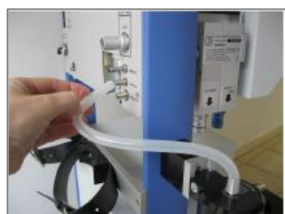
شکل ۱۲- محل نصب شیلنگ ساکشن
