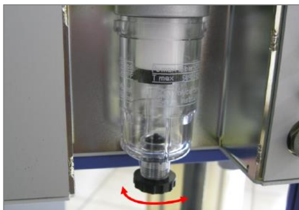
شکل ۸۰- باز کردن پیچ برای تخلیه آب
