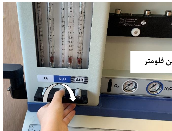
شکل ۲۲- جهت باز و بسته کردن فلومتر
