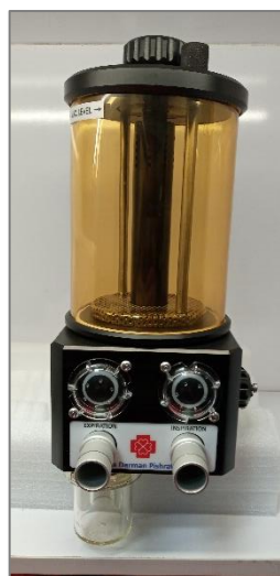
شکل ۳۵- نصب شیشه کنیستر به قسمت ابزوربر
