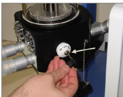
شکل ۸۳- نصب کابل سنسور اکسیژن به سنسور
