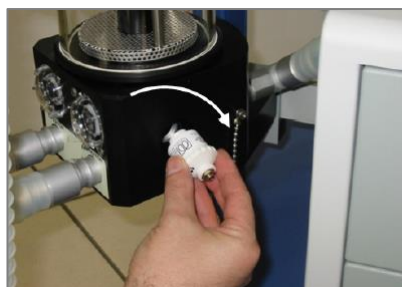
شکل ۸۲- قرار دادن سنسور اکسیژن در بلوک ابزوربر
